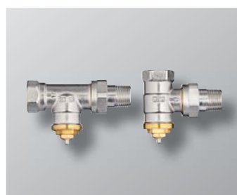
Zestaw podłączeniowy kątowy lub prosty z nastawioną wstępnie wartością k_v . 5 wartości nastaw, 2 rodzaje zaworu.
